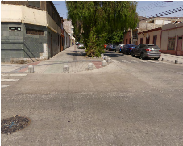
Figura 90 El cruce peatonal debe, en lo posible, ser una extensión continua de la vereda, evitando desviaciones innecesarias. [Barrio Estación]
