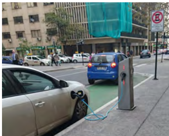
Figura 315 _Tótem de carga sobre la acera, con facilidad para manipularlo en el vehículo. [Santiago, Región Metropolitana]
