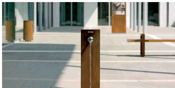
Figura 305_ Diseño adecuado con terminación asociada a la propuesta. Un diseño descendente debe siempre incorporar una rejilla en el suelo.
