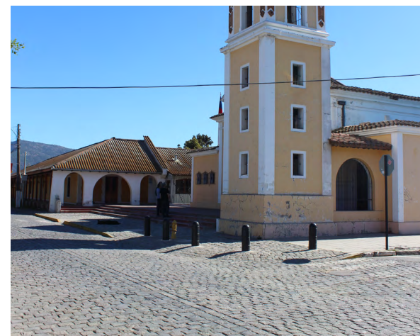
Figura 127_ El uso del mismo material en la calzada y vereda debe limitarse a espacios particulares, como áreas patrimoniales y con las medidas de seguridad necesarias. [Peumo, Región de O'Higgins]
