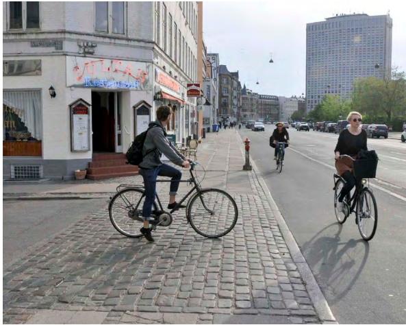
Figura 89 Un cruce tipo acera continua contribuye a disminuir la velocidad de los vehículos y genera una extensión del espacio peatonal. [Copenhague, Dinamarca]
