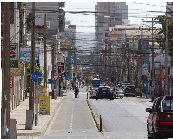
Figura 236_ Señalética de infraestructura de ciclos ubicada en el borde exterior de la solera, sin interrumpir flujo peatonal o de ciclos. [Barrio Estación]
