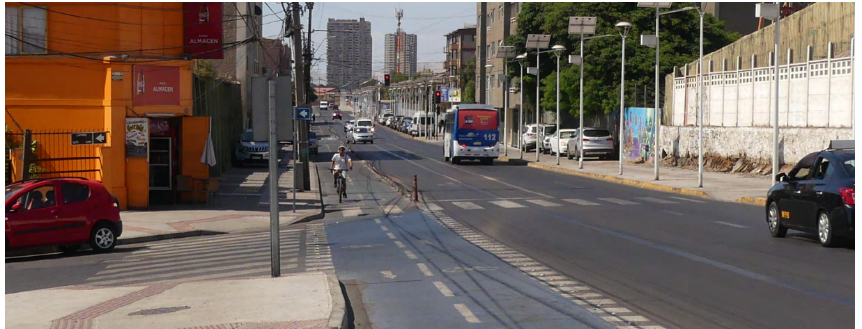
Figura 237_ Señalética vial ubicada de forma que obstruye un cruce peatonal. [Barrio Estación]
