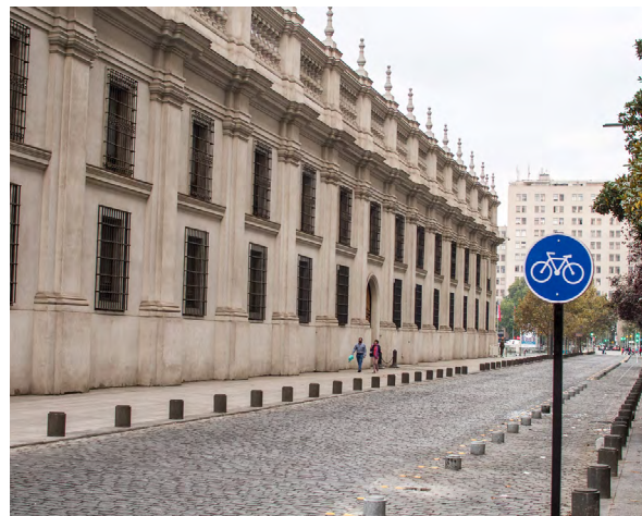
Figura 137_ El uso de texturas en la calzada vehicular contribuye a disminuir la velocidad de los autos y a mejorar el entorno visual del espacio público. [Santiago, Región Metropolitana]
