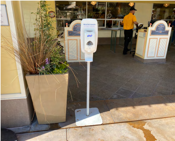
Figura 313_ Un dispositivo anclado a una estructura poco resistente no es adecuado para el espacio público. [Los Ángeles, EEUU]
